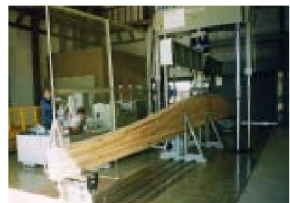
日向駅舎屋根梁実大曲げ試験
