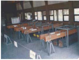
曲げクリープ試験の様子
