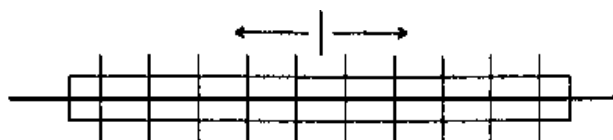
図2-1 ボルト締付け順序
