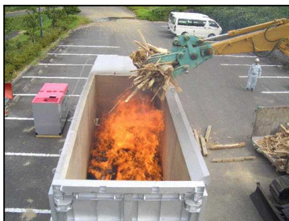
(組立型) 焼却用廃材の投入
