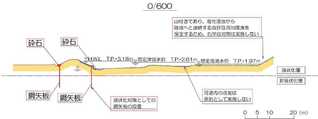
図 5-2 熊野江川河道改修断面図
