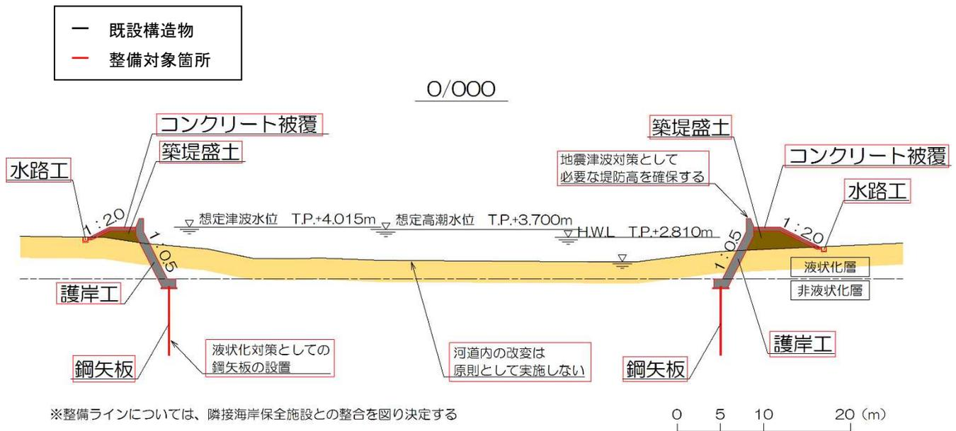
図 5-2 赤岩川河道改修断面図
