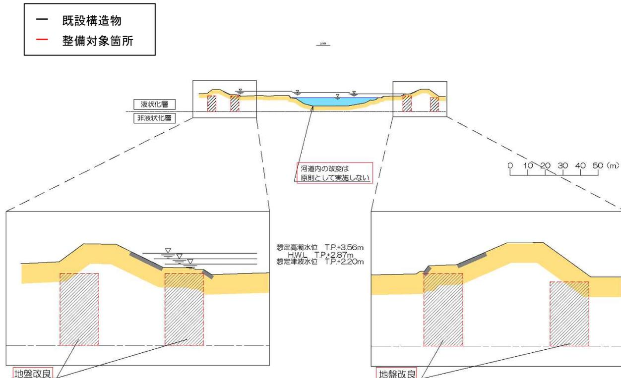
図 5-2 加江田川河道改修断面図
