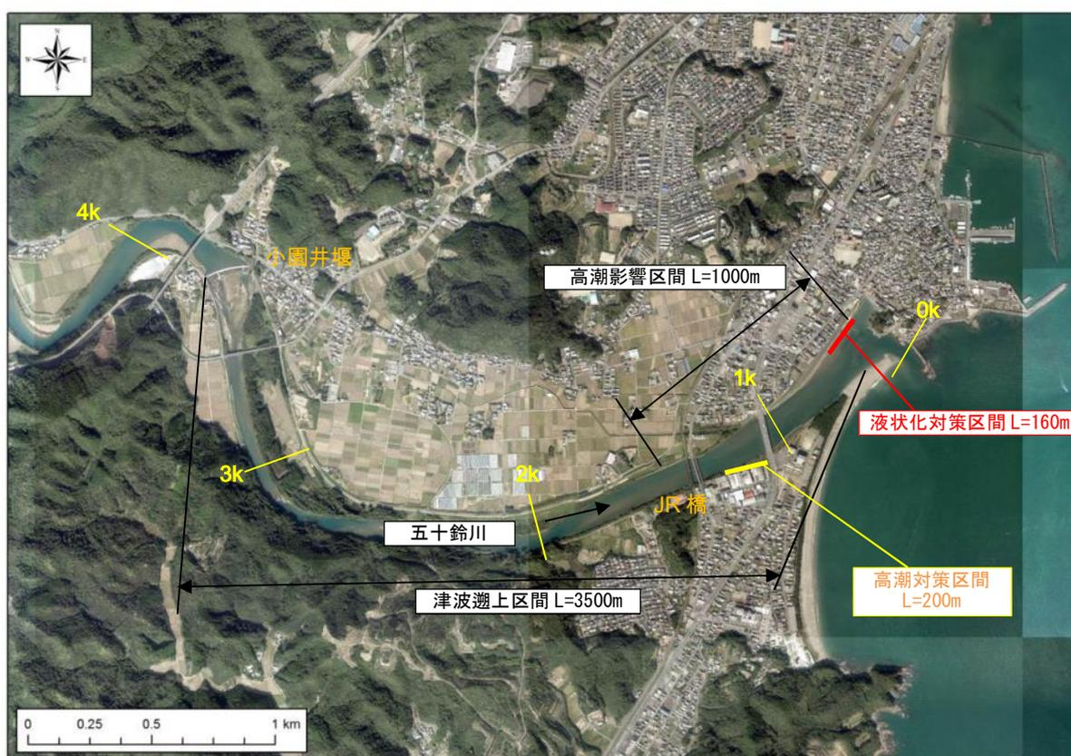
図 5-4 五十鈴川における高潮、地震・津波対策の整備区間図
