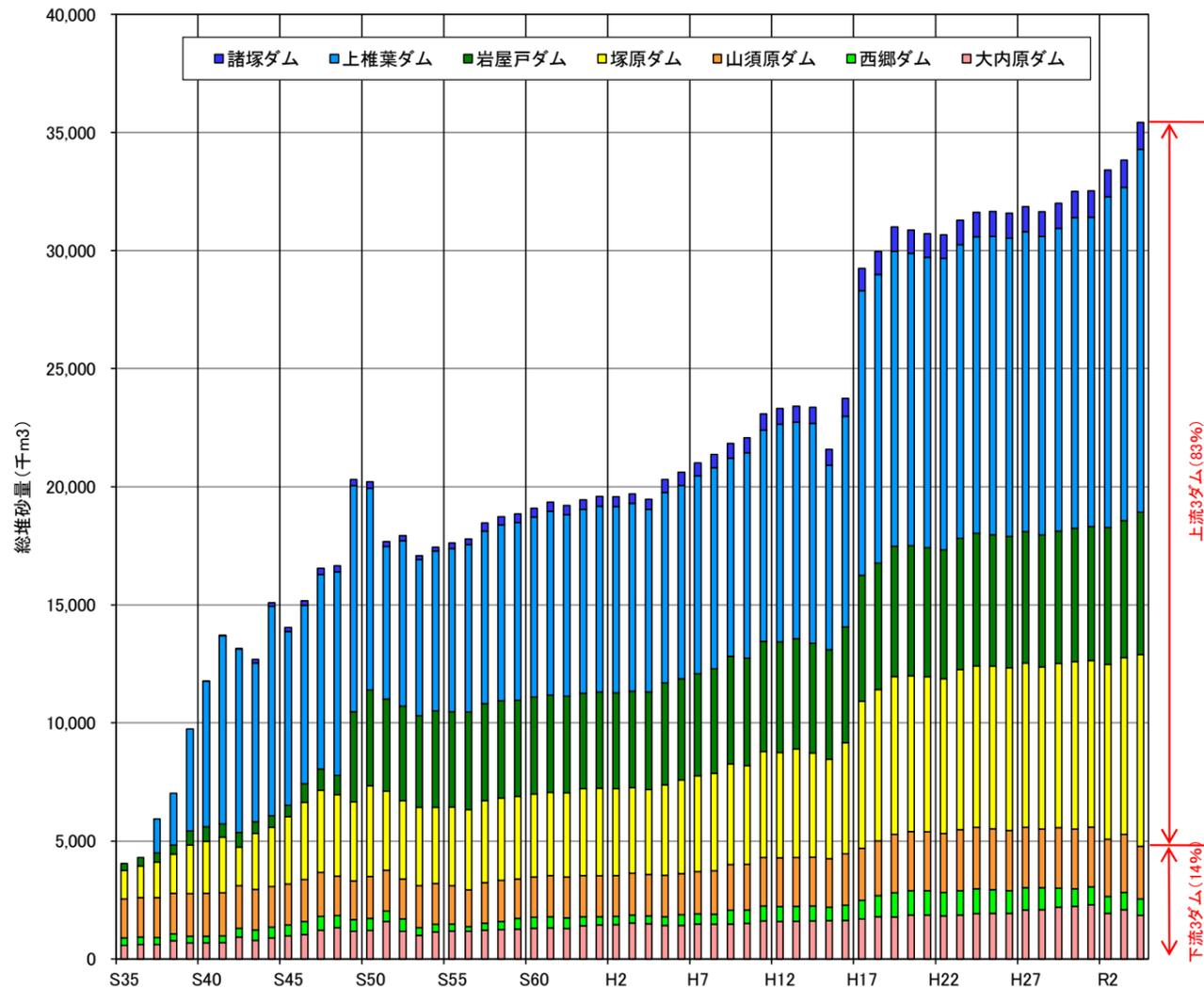
図1-6 ダム堆砂量の経年変化
