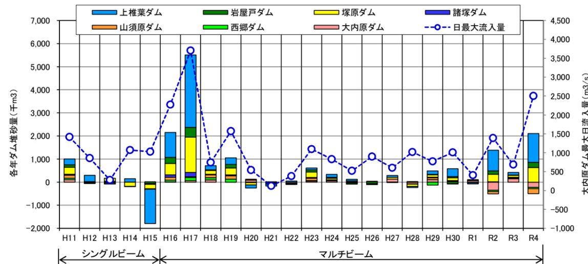
図1-7 ダム堆砂量と最大日流入量の経年変化 ※日流入量：毎正時流入量の24時間平均値
