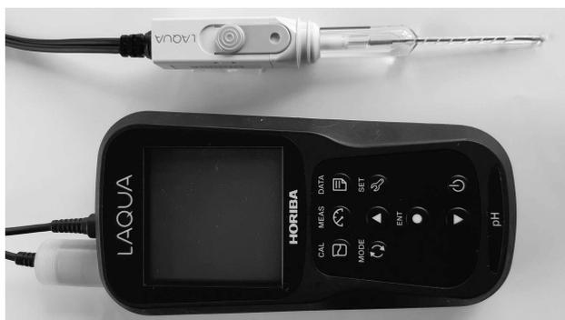
図 5 pH メーター（下）とマイクロ電極（上）
