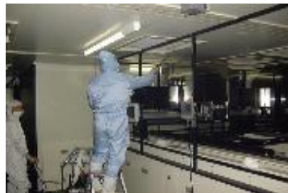
クリーンルーム清浄度測定
