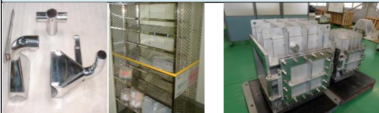
各種精密板金加工部品 技術：精密板金加工 + 表面処理
