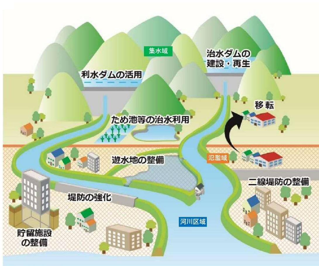
「流域治水」とは、堤防整備、ダム建設・再生などの対策をより一層加速させるとともに、さらに集水域（雨水が河川に流入するエリア）から氾濫域（河川等の氾濫により浸水が想定されるエリア）にわたる流域に関わる全員で水災害対策を行う考え方です。
