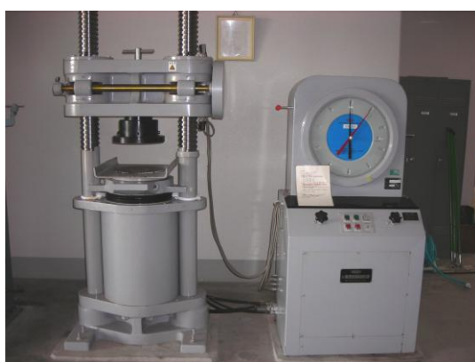
コンクリート圧縮試験機 (2,000 k N)
