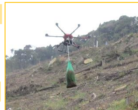
ドローンによる苗木運搬
