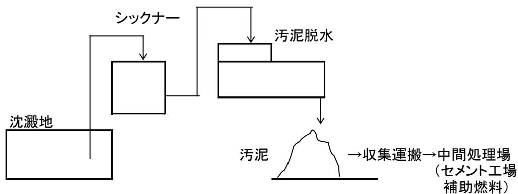
図 4 産業廃棄物の一連の処理の工程(廃油:ディーゼル発電機)
