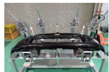
バンパー穴あけ機製作
