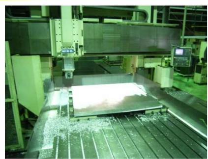
大型五面加工機による
