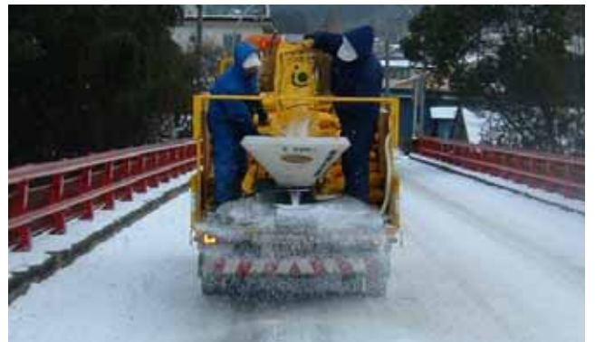
凍結した道路を溶かすため、塩化カルシウムを散布する土木課職員
