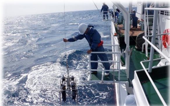
〈写真〉CTD採水器による海洋観測
