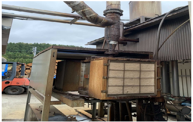
5-(1) スギ精油回収装置
