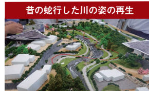
模型実験による洪水時の安全性の確認
