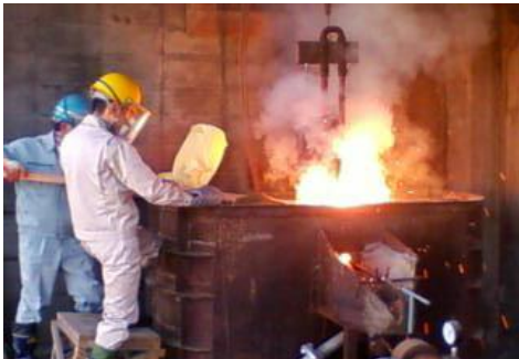
鶏糞燃焼灰を原料とした熔成肥料の試作状況
