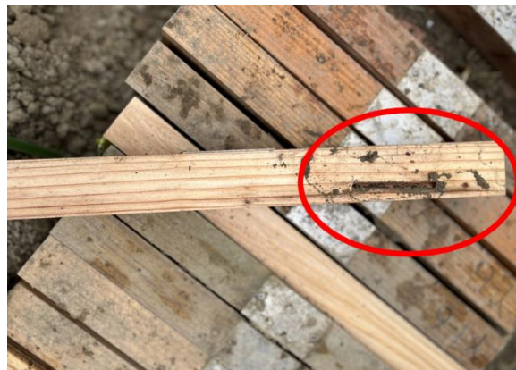
図3 シロアリによる食害を受けた無処理スギ辺材試験体（6か月後）
