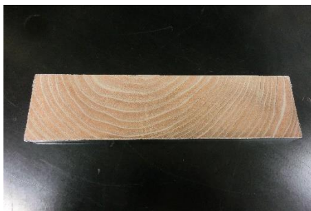
写真1 吸放湿量試験体
