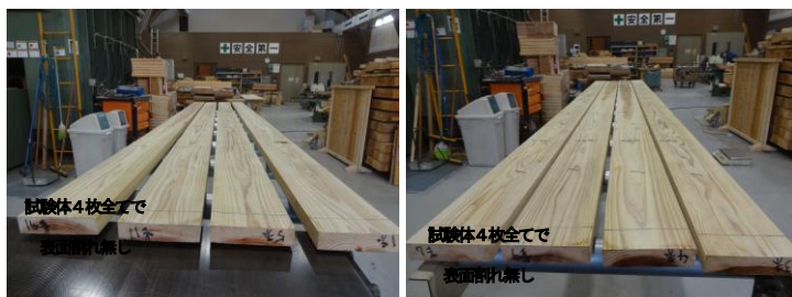
図 3 30mm 厚 乾燥終了後の表面（左：105℃-23h 右：105℃-28h）
