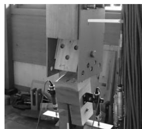
(iii) 木部の横引張破壊
