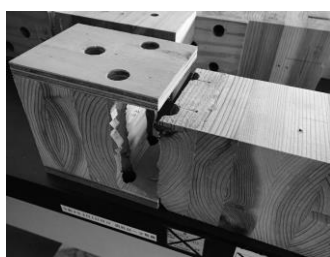
(iv) ボルトからの割裂破壊
