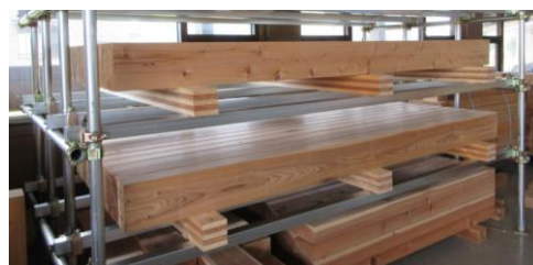
写真 1 スギ心去り平角試験体の静置状況
