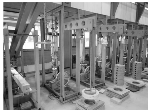
写真 3 長期試験の全景
