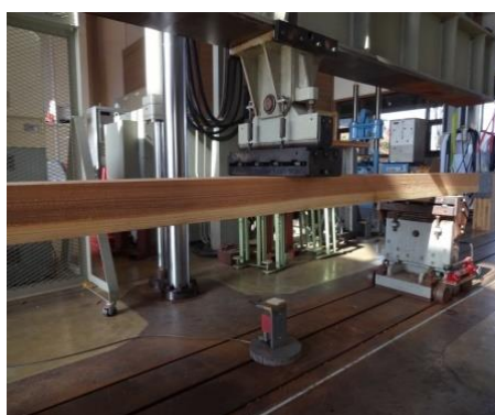
図 1 中央集中荷重方式による曲げ試験
