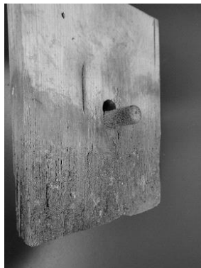
図4 支圧試験破壊性状
