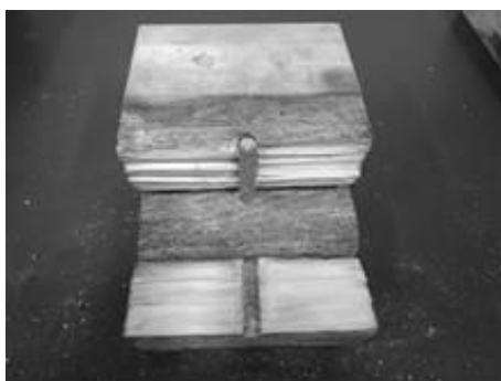
図5 単体試験体破壊性状
