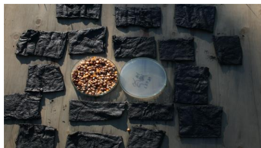
写真2 鳥摂食阻害試験（黒い部分が木タールを含浸させたオイル・有機溶剤吸収材）
