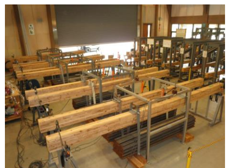
図 1 クリープ試験の状況
