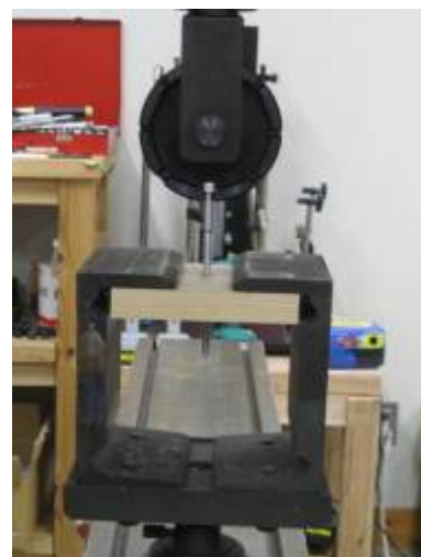
図 1 引き抜き試験風景
