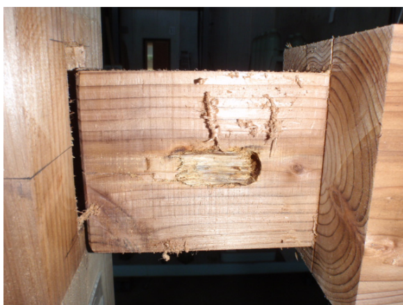
写真 1 手加工の破壊状況
