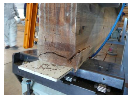
写真 3 支点部の破壊状況
