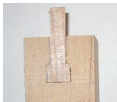
写真 1 ダボ接合部断面
