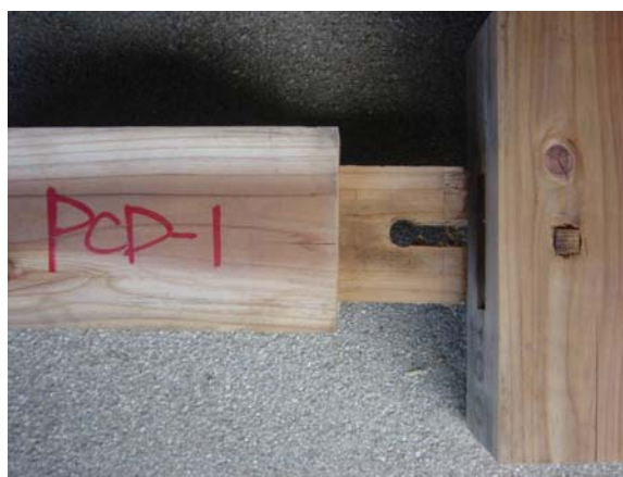
写真 2 機械加工の破壊状況
