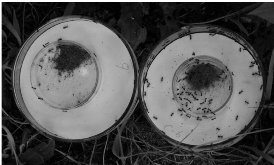
図1 スギ材精油のアリ忌避試験の様子(左：1%添加、右：コントロール)
