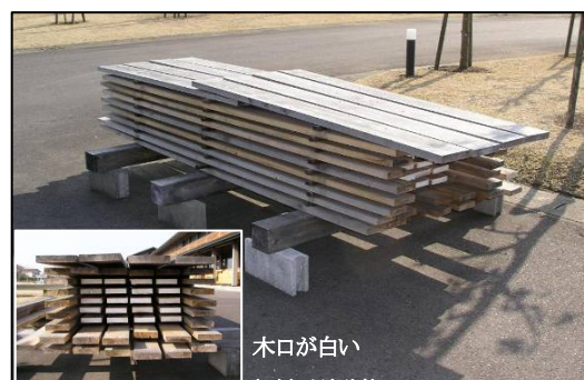
図3 天然乾燥試験体 棧積み状況
