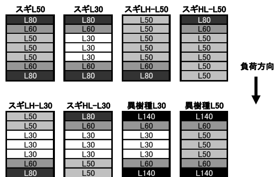
図2 集成材(梁部分)のラミナ構成
