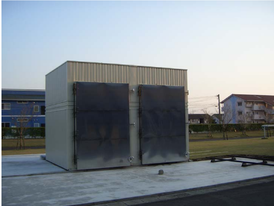
図 2 廃熱を利用した木材乾燥養生庫
