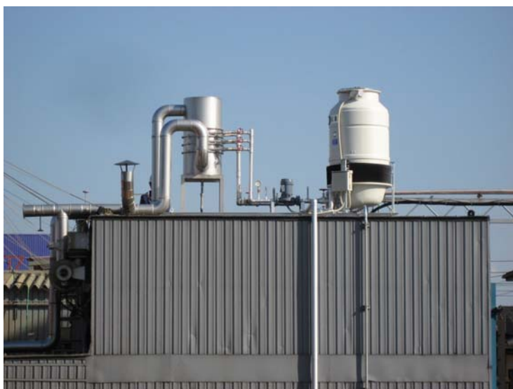
図1 稼働中の木材乾燥機に設置したスギ精油採取装置
