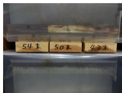
写真 1 熱板処理の状況
