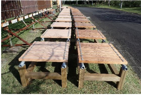
写真1 曲げ・割裂試験体
