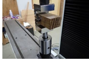
写真3 強度試験(曲げ、割裂、ねじ引抜)
