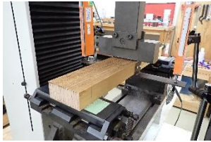
写真1 曲げ・割裂試験体
