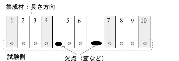
図 3 DOL 試験体の採取方法
