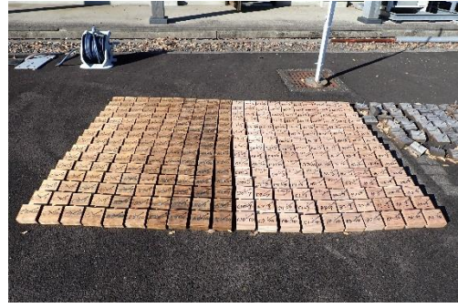
写真2 ねじ引抜試験体
