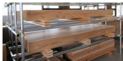
写真 1 スギ心去り平角試験体の静置状況
