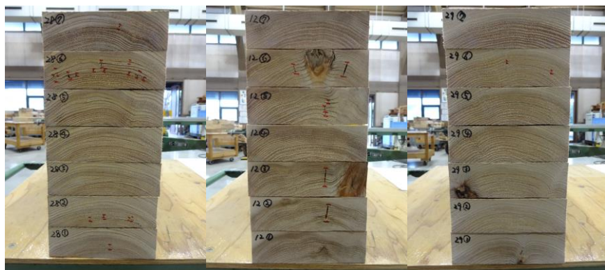
写真2 内部割れの状況
