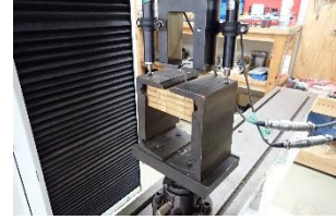
写真2 ねじ引抜試験体
