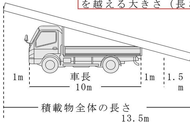
積載物の長さは車長＋その10分の1（11m）を2.5m超過している。積載の方法は車体の前後から車長の10分の1まで許可不要であるので、制限を越えるのは後ろ1.5mとなる。よって、記載を要するのは制限を越える大きさ（長さ）の2.5mと、制限を越える積載の方法（後）1.5mです。
